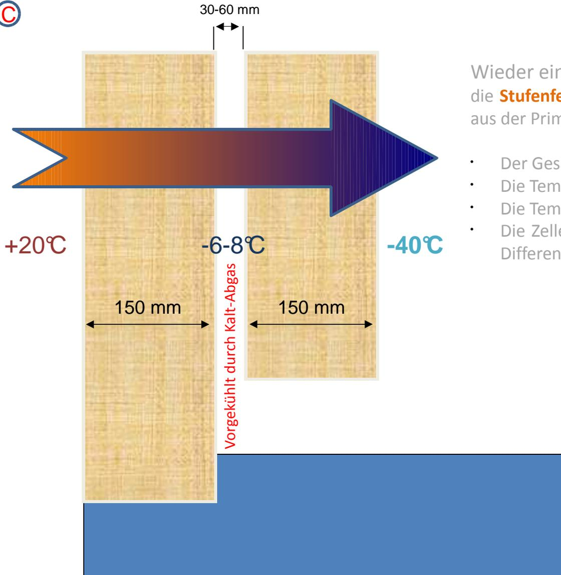
Wieder eine Innovation der NNC-MED Consulting, die **Stufenfeld-Zelle mit Zwischenraumkühlung** durch Abgas aus der Primärkühlung.
